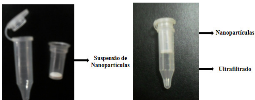
Figura 5: Determinação da eficiência de encapsulação pela técnica de filtração-centrifugação.
