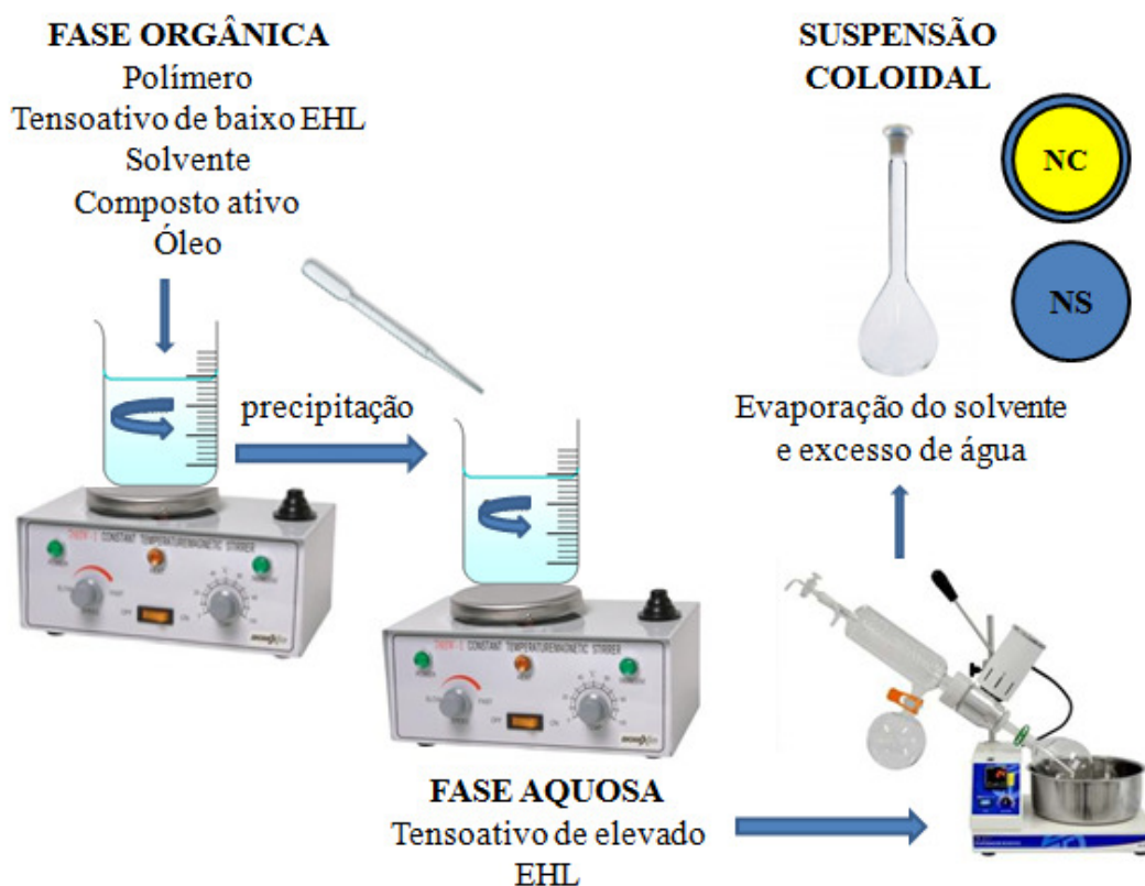
Figura 4: Esquema de preparo de nanopartículas pelo método de nanoprecipitação.
